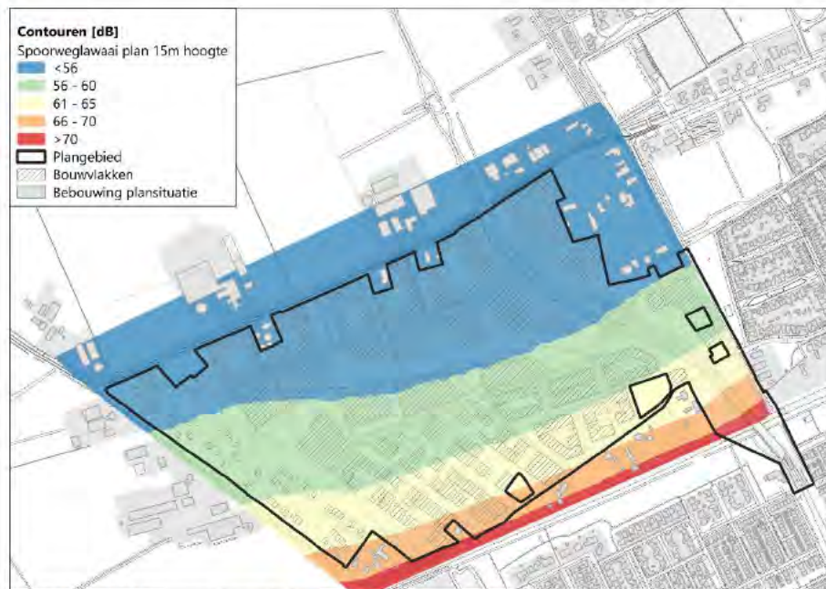
Abbeelding 4.13 Spoorweglawaai plansituatie 15m hoogte
